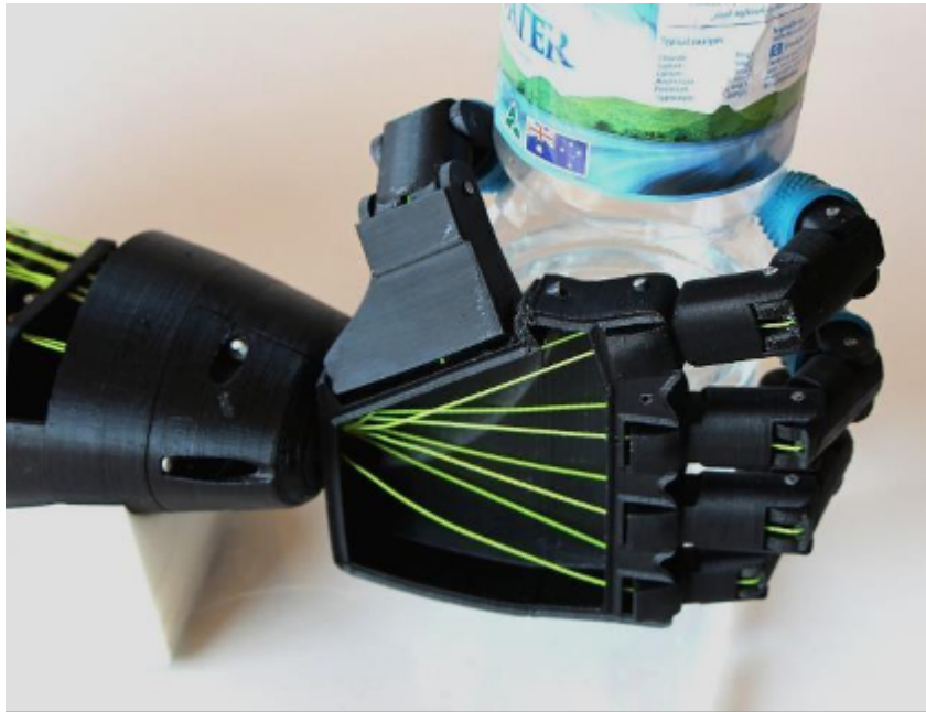
8 pav.: Bioninė ranka, laikanti objektą
