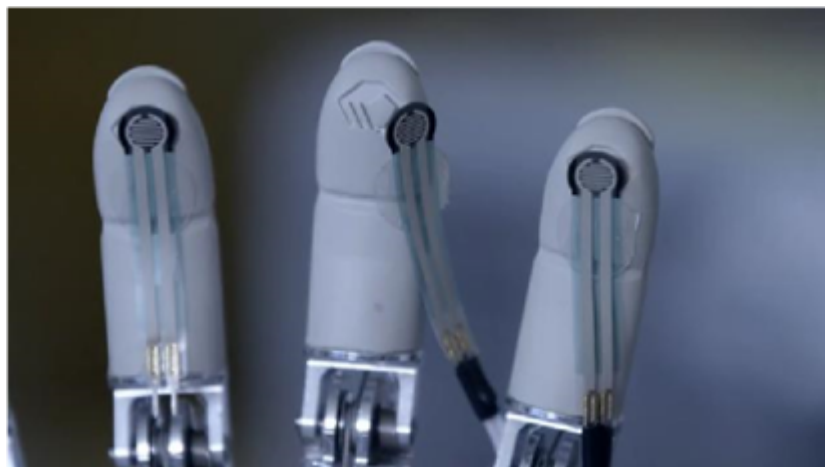
9 pav.: Jėgos jutikliai, išdėstyti pirštų galuose
