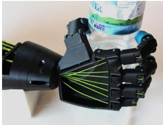
Abbildung8 : Bionische Hand, die einen Gegenstand hält
