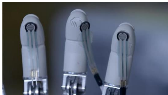
Abbildung9 : Kraftsensoren an den Fingerspitzen
