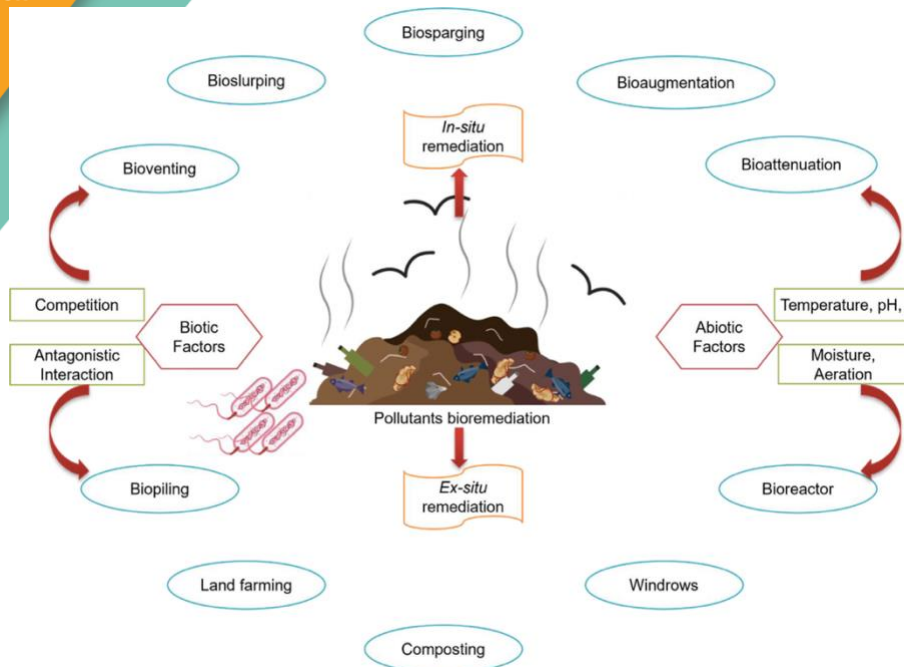
Abbildung 3 – In-vitro-Mechanismen der bakteriellen Bioremediation in der verschmutzten Umwelt, Quelle: Sharma et al., 2022
