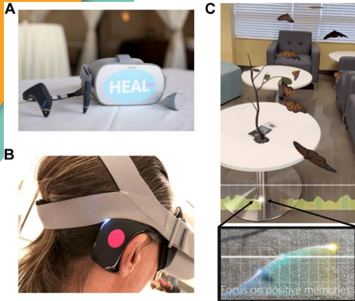
Abbildung 8. Beispiele für die Ausrüstung und das visuelle AR-Erlebnis: (A) Muse-Stirnband für Neurofeedback und das Healium-Augmented-Reality-Headset. (B) Das Healium-Neurofeedback-Setup wird getragen. (C) Ein Screenshot der AR-geführten Meditation mit Chrysalis-Hatching-Neurofeedback. Unten sehen Sie eine vergrößerte Darstellung der Schwellenlinie (durchgezogen)
