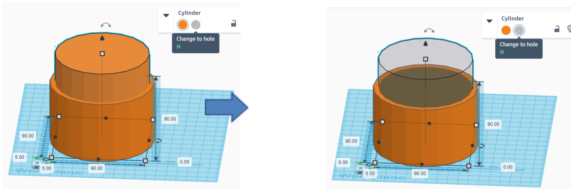
Σχήμα 16 Αλλαγή υλικού κυλίνδρου σε "ΤΡΥΠΑ"
